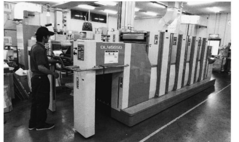
世界初となる「LED-UV水なし印刷」の運用を始めた「オリバー 466SD」
